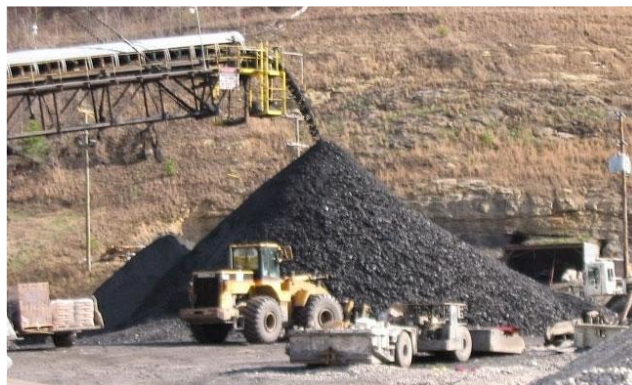
Gambar 7. Proses pengadukan material di stock pile (sumber : dokumentasi lapangan, 2024)
