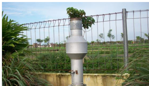
Gambar 1. Alat penakar curah hujan Ombrometer
