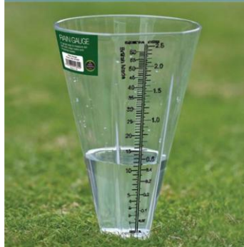
Gambar 2. Alat penakar curah hujan Pluviometer
