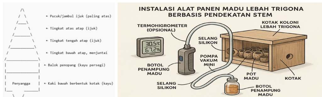
Gambar 1. Kerangka kotak budidaya dan alat panen lebah trigona berbasis STEM Materi pelatihan:
